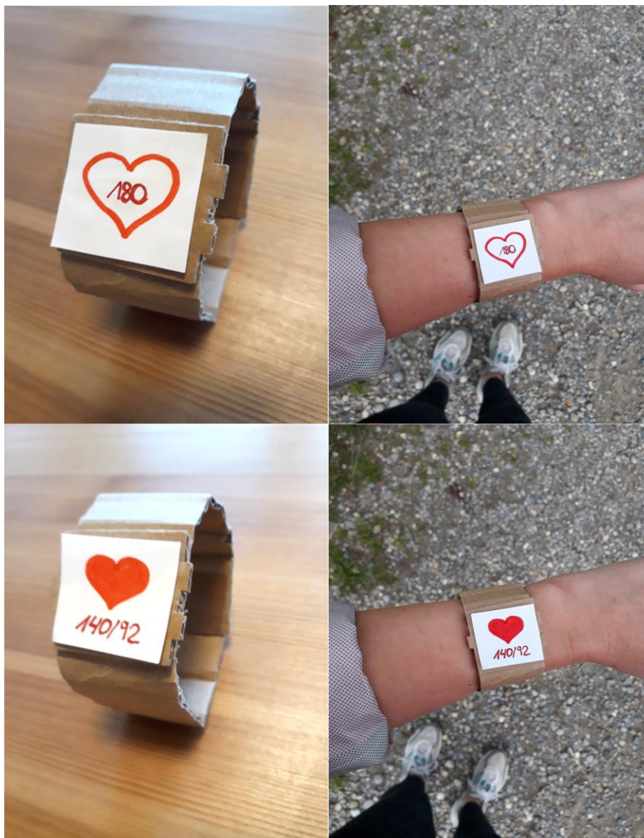
Abbildung 46 - Beispiel eines Kartonprototyps der Smartwatch der YPRC-Fallstudie
